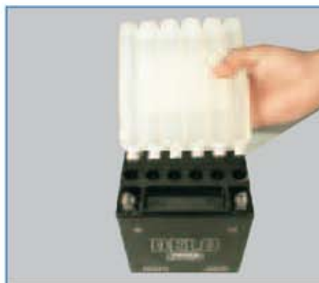
3. Batterij vullen met het zuur
