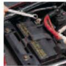
2. De minkabel voor de pluskabel losmaken van de batterij.
