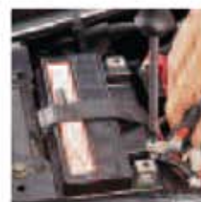
5. De pluskabel voor de minkabel bevestigen.
