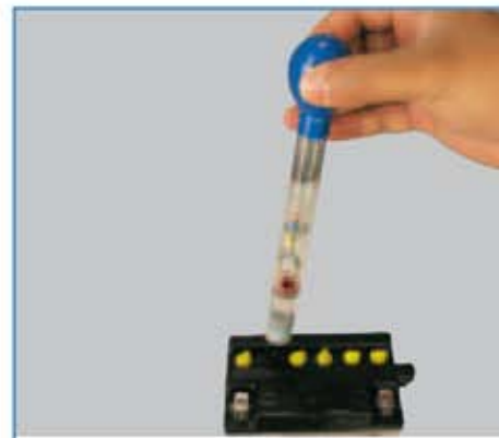
De dichtheid van het zuur meten
