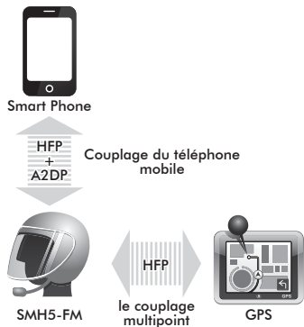
Couplage multipoint avec superposition du GPS
